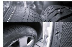
AUF BESCHÄDIGUNGEN AN DEN REIFEN IST AUCH ZU ACHTEN UND DIES REGELMÄSSIG ZU KONTROLLIEREN. ACHE DABEI AUF **RISSE, BEULEN** UND **GEGENSTÄNDE**. DESWEITEREN KANN EINE FEHLERHAFT EINGESTELLTE RADAUFHÄNGUNG DAZU FÜHREN DAS DER REIFEN EINE EINSEITIGE ABNUTZUNG AUFWEIST
